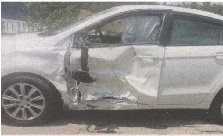
Kereta remuk di bahagian penumpang depan kiri akibat pelanggaran.
